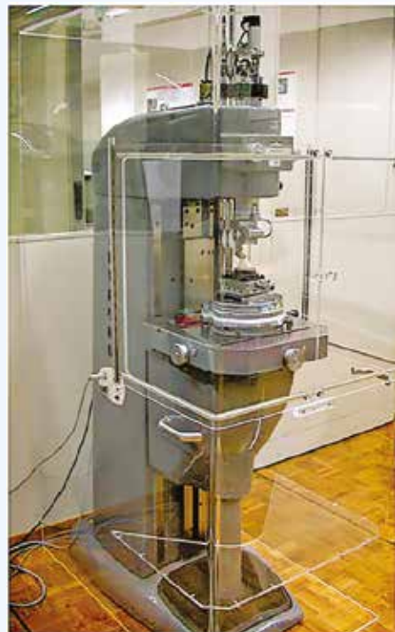
Рис. 7. Прибор Talyrond 73 для измерения отклонения от круглости, защищенный корпусом из оргстекла.
