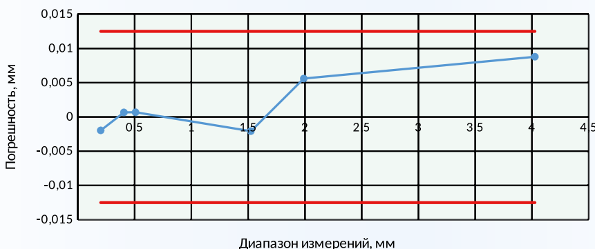
Рис. 4. Результаты поверки системы измерений толщины ИТ-3А-7К
