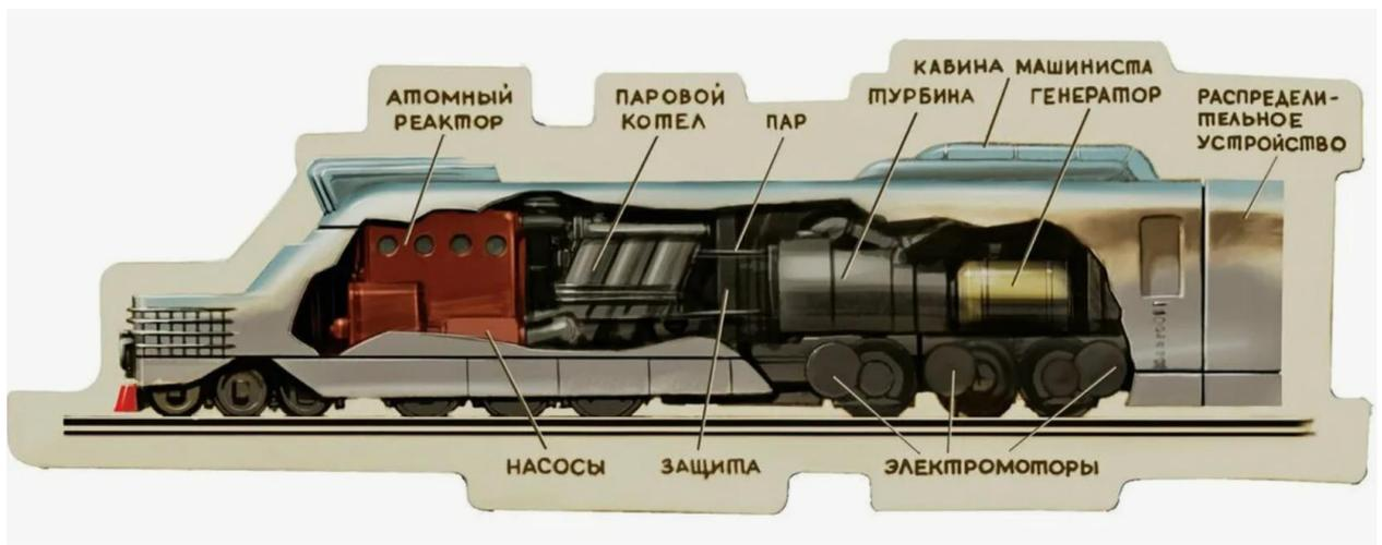
Рис. 1 Схема атомовоза
