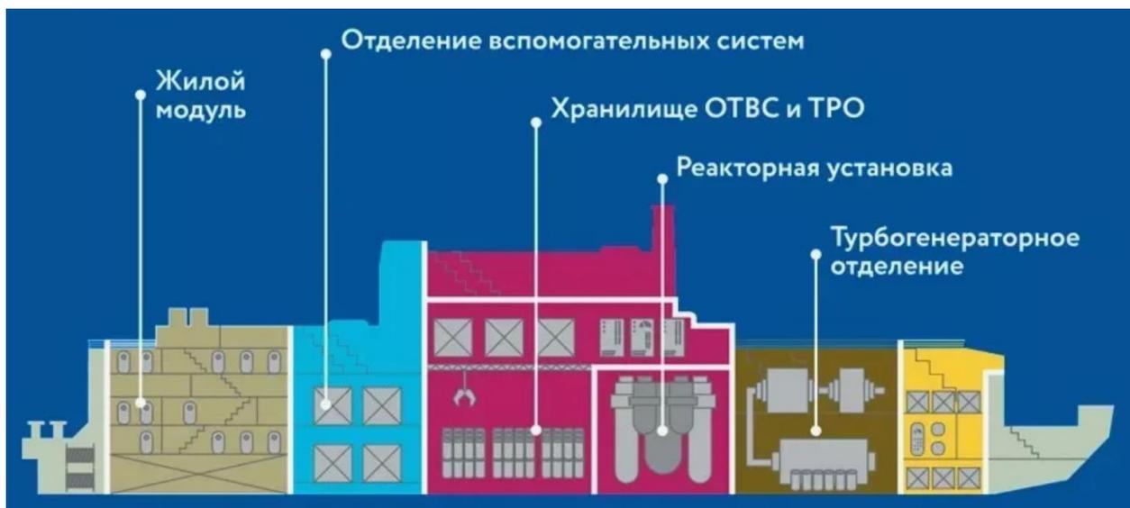
Рис. 2 Компоновка плавучей атомной теплоэлектростанции
