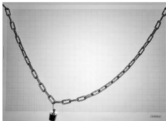
Рис. 7. Фотография цепи с грузом на фоне миллиметровой бумаги
