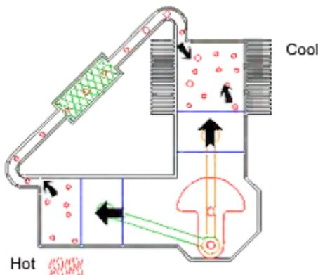
**Шаг 1: Сжатие.** В этой точке большая часть газа перемещается в холодный цилиндр. По мере того, как газ охлаждается и сжимается, оба поршня позиционируются внизу.
