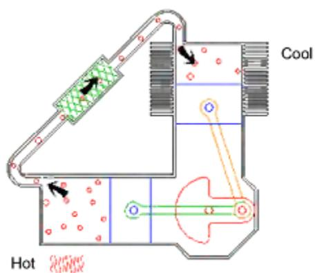
**Шаг 4: Передача тепла.** В этой точке газ расширился (примерно втрое в этом примере). Большинство газа (около 2/3) по-прежнему расположено в горячем цилиндре. Маховик перемещает кривошип на следующие 90 градусов, перемещая основную часть газа в холодный цилиндр для завершения цикла.
