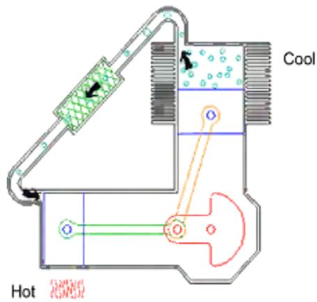
**Шаг 2: Передача тепла.** Теперь по циклу газ по-прежнему находится в холодном цилиндре. Маховик перемещает кривошип на 90 градусов, возвращая газ в горячий цилиндр.
