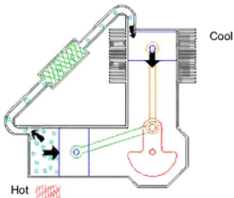
**Шаг 3: Расширение.** Теперь, большая часть газа только что поступила в горячий цилиндр. Газ нагревается и расширяясь перемещает оба поршня внутрь.
