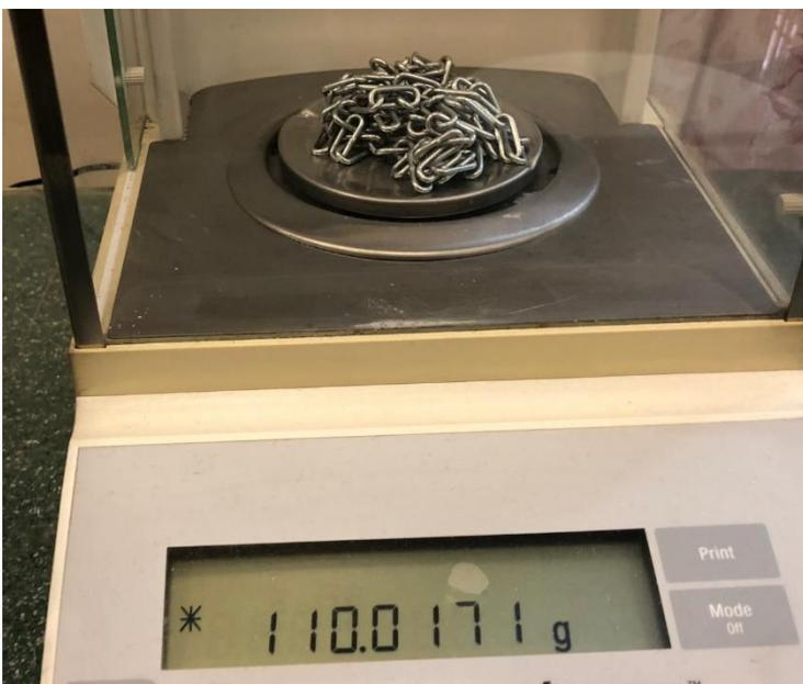
Рис. 11. Определение массы цепи
