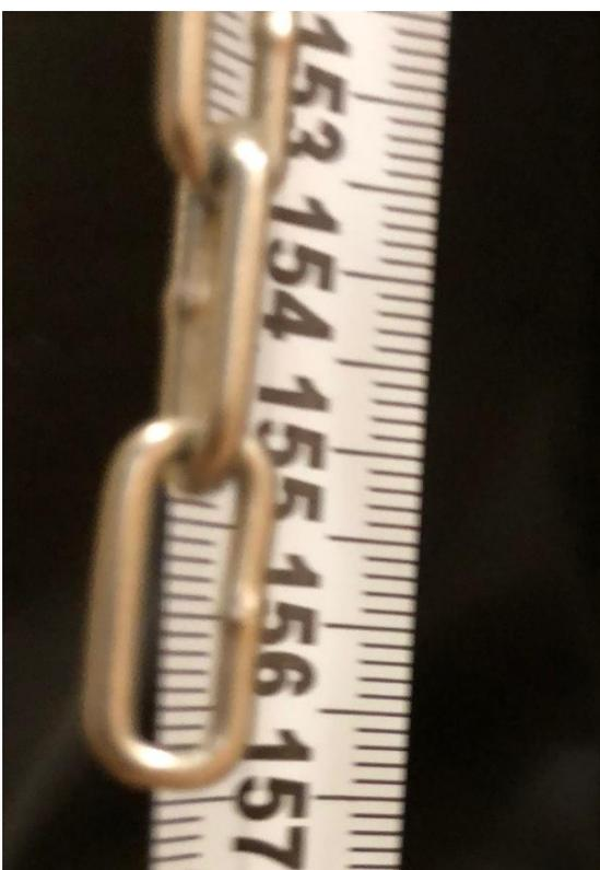
Рис. 12. Определение длины цепи
