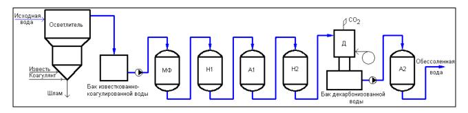
Рис. 1. Классическая схема обессоливания воды
