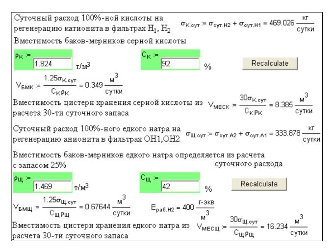
Рис. 4. Программированный расчет схемы нейтрализации
