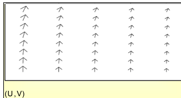
Рис. 12.8. Векторное поле скорости вблизи стенки при вдуве
